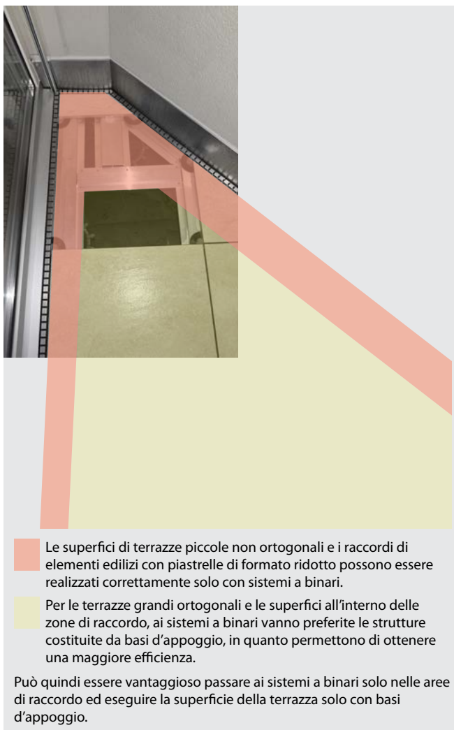
Fig. 21: In presenza di raccordi ortogonali difficili, la semplice esecuzione con basi d'appoggio dovrà eventualmente essere integrata localmente con sistemi a binari.
